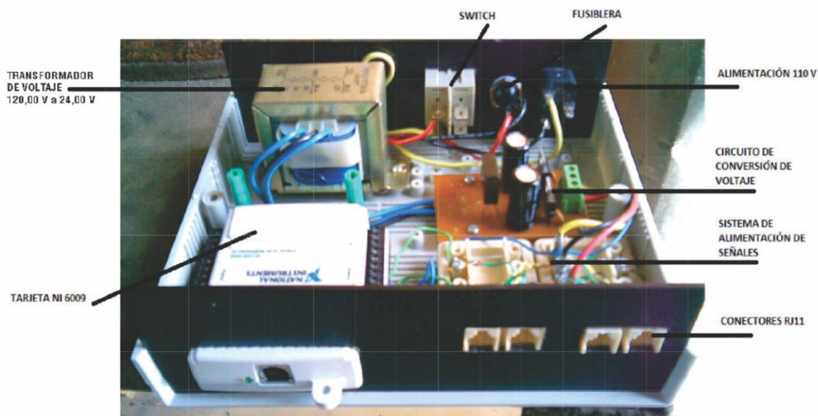
Figura 8. Módulo de adquisición de datos y alimentación de voltaje.
