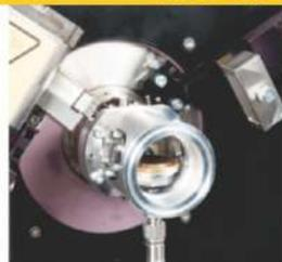
**Porta muestras de presión variable:** para investigación sobre interacciones solido-gas en un rango de presiones desde -3 atm. (Vacío) hasta 30 atm. (440 psi).
