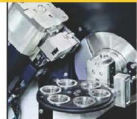
**Cambiador de muestra:** nuestro cambiador de muestra automático de seis posiciones, permite una operación desatendida del difractómetro.
