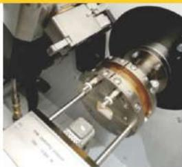
**Cámara de temperatura variable:** permite calentar la muestra hasta 500°C en diferentes atmósferas tales como aire, nitrógeno (N) o Argón (Ar).
