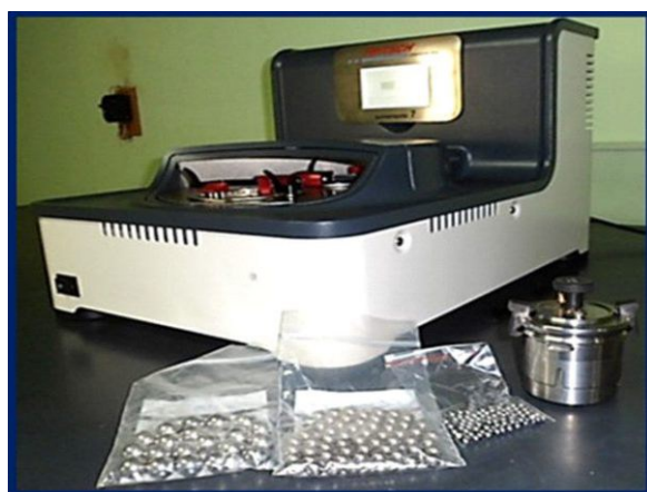
Fig. 1. Molino Planetario micro mill PULVERISETTE 7.
